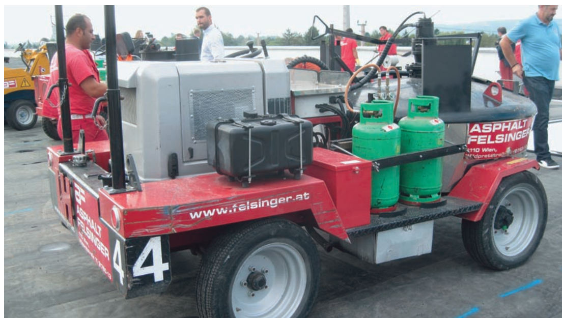
Fig. 2 Veicolo per il trasporto dell'asfalto colato
