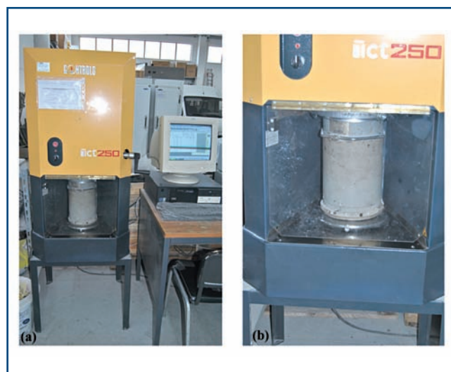
Fig. 8 Pressa giratoria (a) e particolare della fustella (b)
