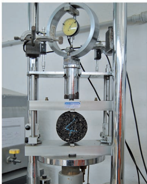
Fig. 10 Apparecchiatura per la determinazione della resistenza a trazione indiretta
