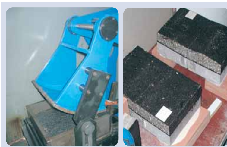
Fig. 2 Dispositivo e provini per la prova di compattazione EN 14692
