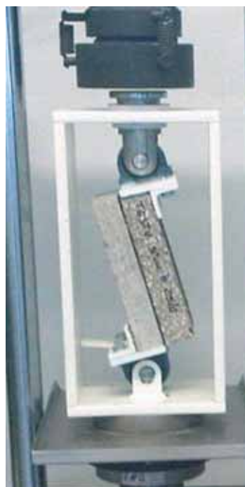
Fig. 3 Prova per la determinazione della resistenza al taglio
