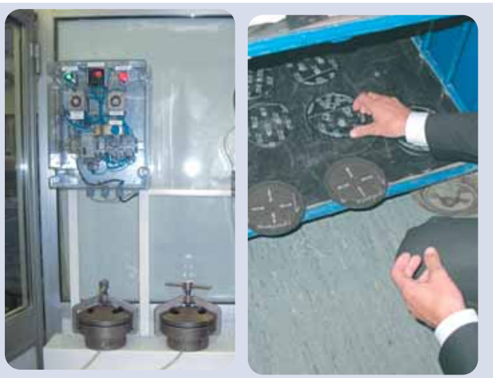
Fig. 1 Apparecchiatura e campioni per la prova di impermeabilità EN 14694
