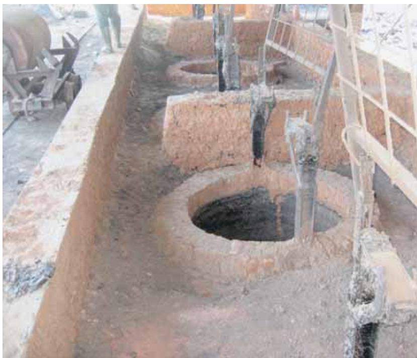
Fig. 3 Le vecchie "caldaie" per la fusione del bitume naturale di Selenizza
