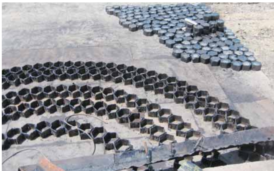
Fig. 9 Le forme esagonali in cui viene colato il bitume fuso, poi macinato
