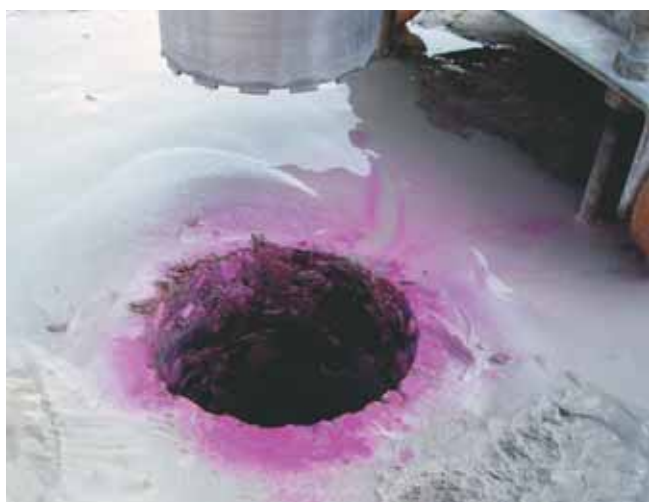
Fig. 4 Foro di carotaggio del terreno stabilizzato
