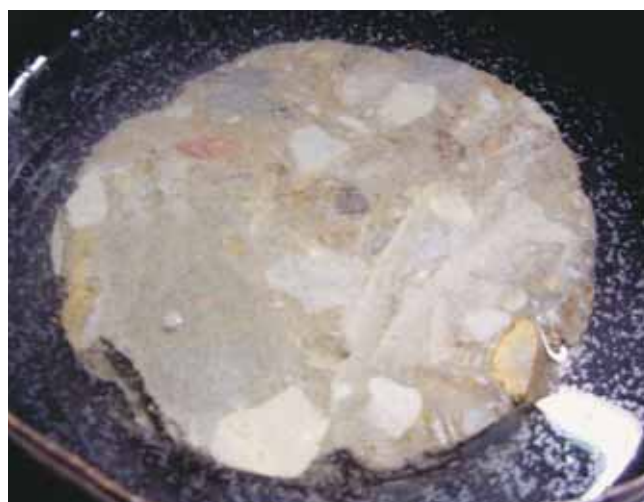
Fig. 6 Campione mantenuti immersi in acqua
