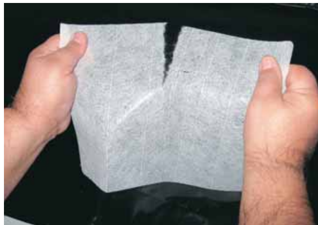
Fig. 3 Tipica armatura di membrana bituminosa
