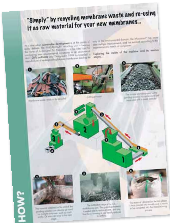
Fig. 2 L'impianto Macaluser integrato nel processo di produzione delle membrane
