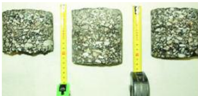
Fig. 2 Campioni prelevati tramite carotaggio
