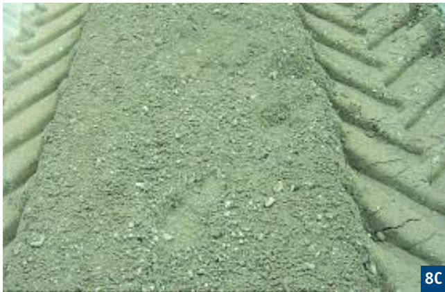
Fig. 8 Stabilizzazione con cemento e bitume schiumato – emulsione bituminosa
