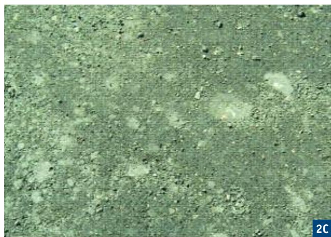
Fig. 2 Stabilizzazione con calce e cemento
