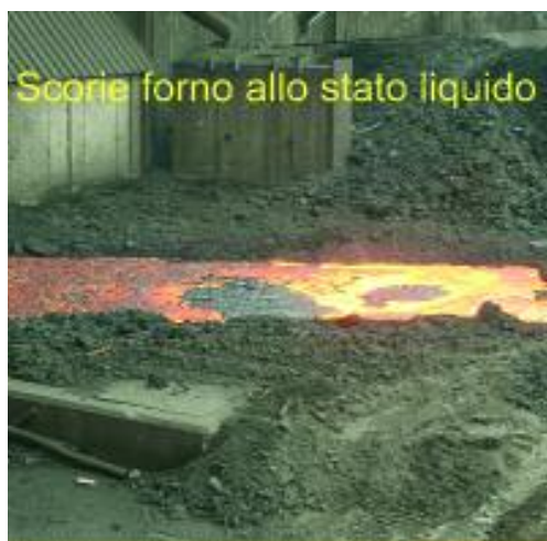
Fig. 3 Raffreddamento controllato ed accelerato delle scorie
