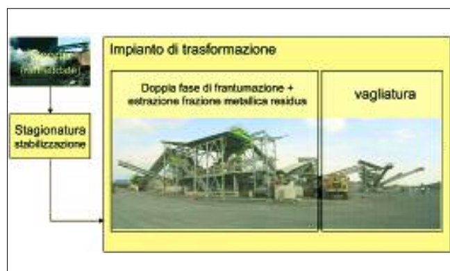
Fig. 4 Impianto di trasformazione – vagliatura degli inerti
