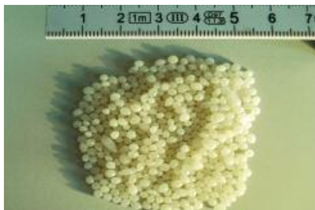
Fig. 1 Cere Fischer-Tropsch (sin.) e DSR (destra) utilizzate nella sperimentazione
