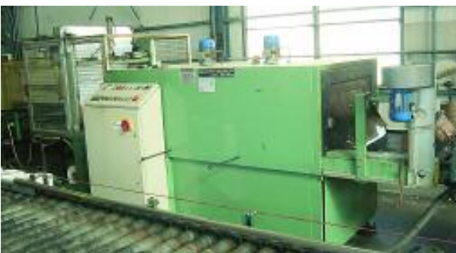
Macchina monoblocco per la termoretrazione del film in PE
