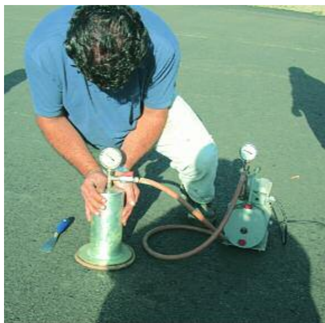
Fig. 14 Prova col vacuometro
