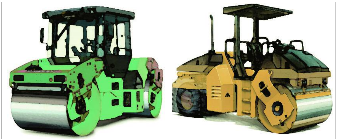
Fig. 4 A sinistra rullo vibrante con due ruote lisce, e, a fianco, rullo combinato
