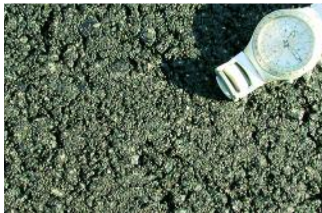
Fig. 4 Superficie finita di un conglomerato semitiepido
