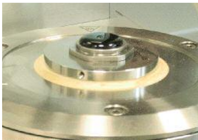
Fig. 4 Provino di bitume sul piatto inferiore del Dynamic Shear Rheometer (DSR) e configurazione di prova
