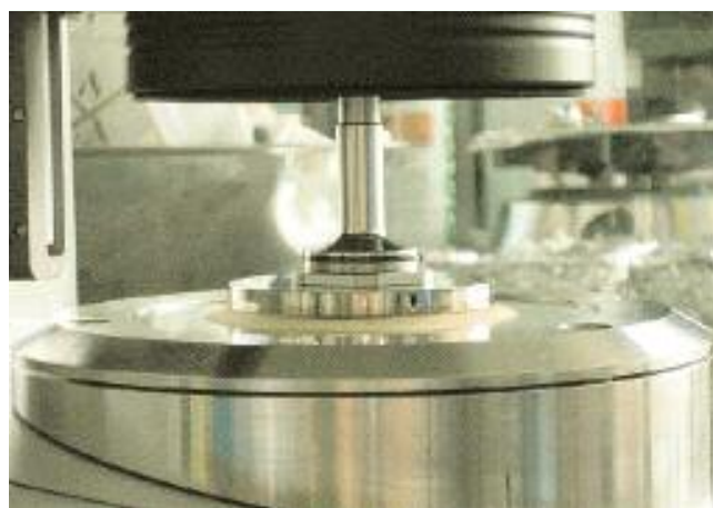
Fig. 4 Provino di bitume sul piatto inferiore del Dynamic Shear Rheometer (DSR) e configurazione di prova
