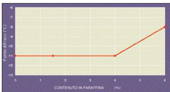
Fig. 4 Bitume 70/100 - Punto di Fraass in funzione del contenuto in paraffina
