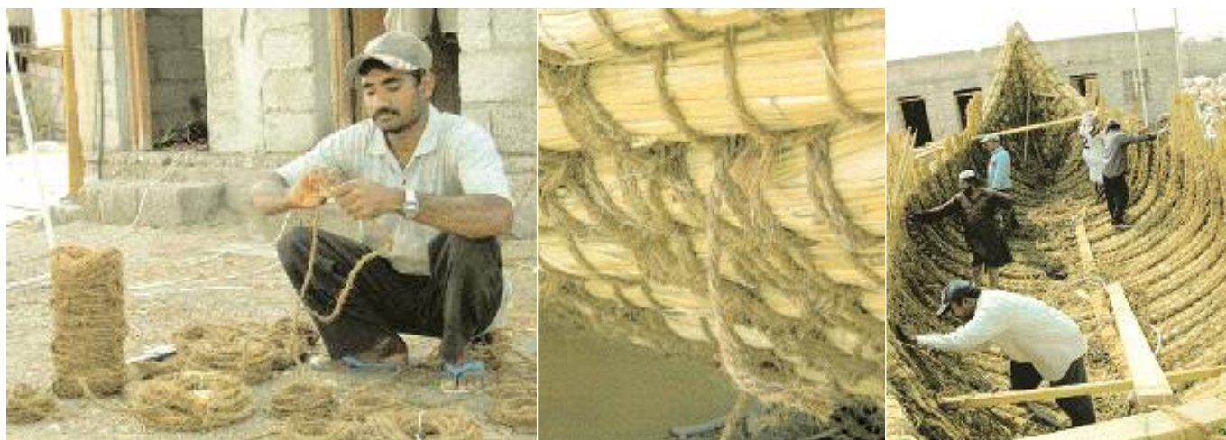
Fig. 9 Particolari della legatura e assemblaggio dello scafo
