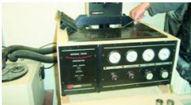
Fig. 2 Il Bending Beam Rheometer ed i casseri per il confezionamento dei provini di bitume
