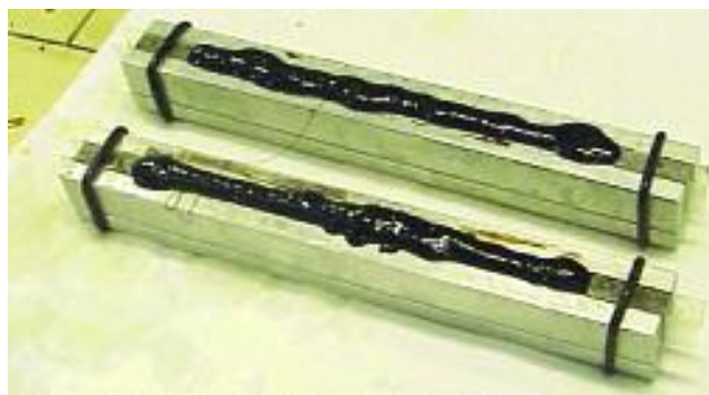
Fig. 2 Il Bending Beam Rheometer ed i casseri per il confezionamento dei provini di bitume
