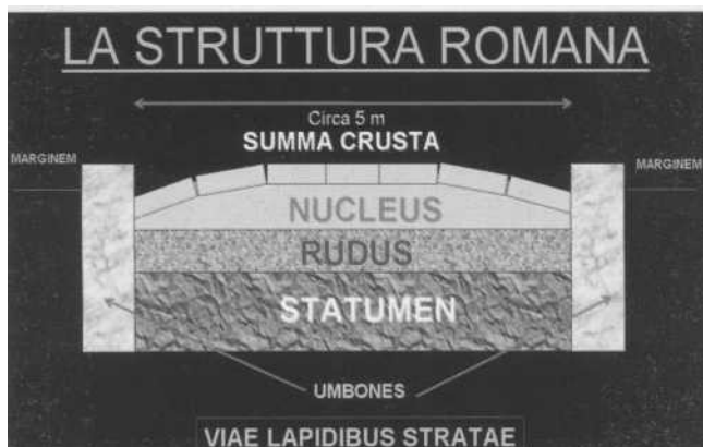
Fig. 2 - Struttura della strada romana
