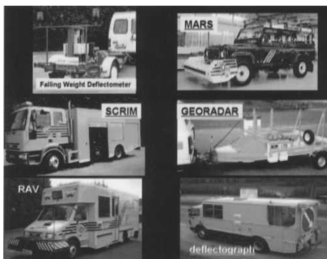
Fig. 9 - Le attrezzature ad alto rendimento per la misura dell'efficienza delle pavimentazioni
