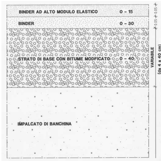
Fig. 2 - Sovrastruttura di tipo B sull'impalcato di banchina
