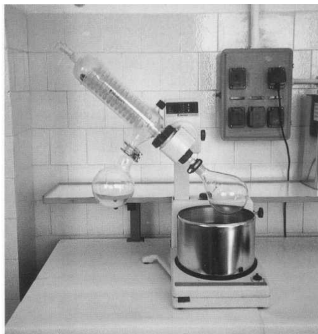
Fig. 2 - Il Rotavapor, utilizzato per il German Rotating Flask Test
