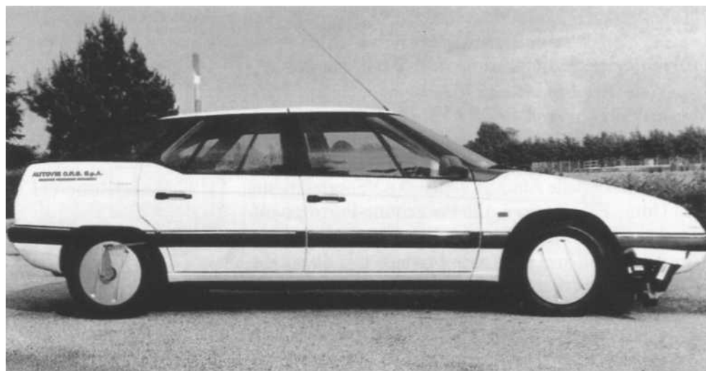
Foto 2 - Misura della regolarità (International Roughness Index), dei profili longitudinali e trasversali con sistemi LASER.
