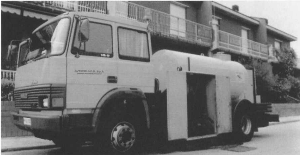
Foto 3 - Misura del coefficiente di aderenza con apparecchiatura SCRIM.
