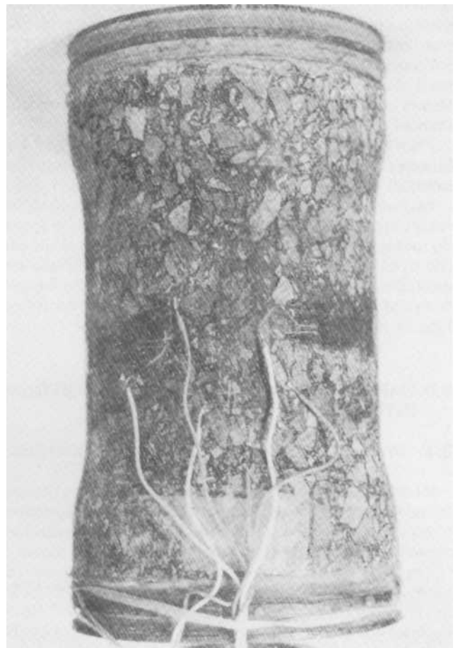
Fig. 2. Campione di conglomerato bituminoso preparato per le prove dinamiche (h = 14 cm; \varnothing = 10 cm).
