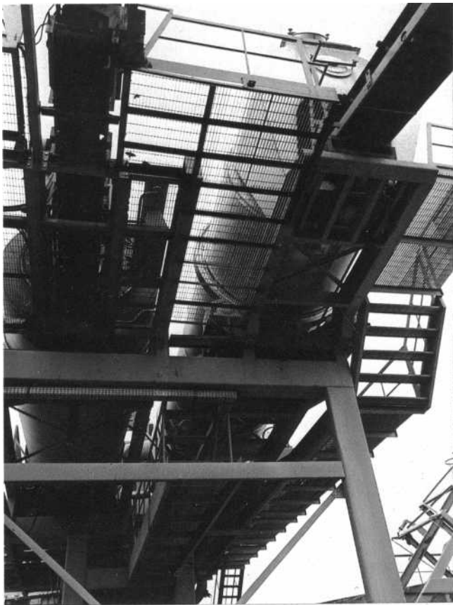
Foto 2. Tamburi essiccatori abbinati: - in quello a destra viene essiccato l'inerte di reintegro - in quello a sinistra viene pretrattato con l'ACF e riscaldato il materiale fresato.
