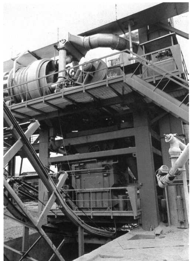
Foto 3. Gli inerti di reintegro ed il materiale fresato pretrattato vengono miscelati ed impastati con il legante di reintegro.
