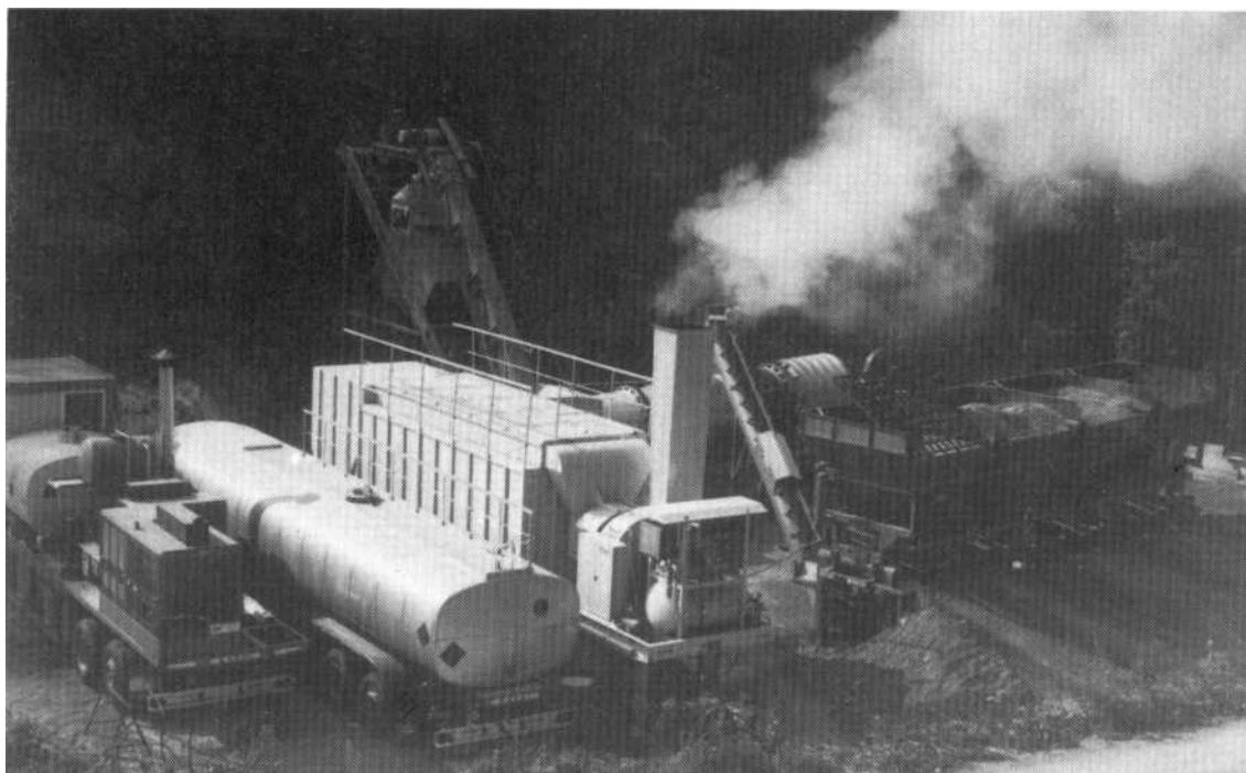
Figg. 7-8 - Riciclaggio in centrale del vecchio conglomerato bituminoso recuperato e riapplicazione del conglomerato riciclato sull'Autostrada Savona-Ventimiglia.
