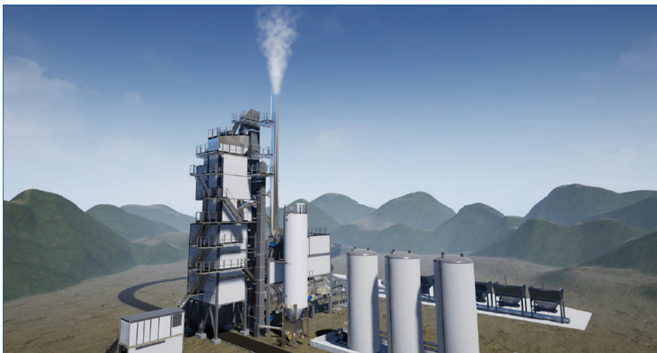
Fig. 6 Impianto tipico di produzione del CB
