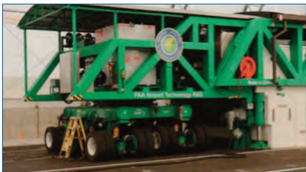
Fig. 4 Il grande simulatore veicolare HVS-A, che può applicare carichi bidirezionali e unidirezionali
