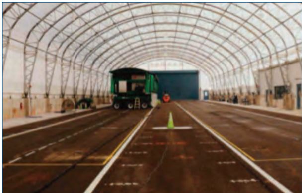
Fig. 2 Le piste indoor per le prove accelerate full-scale del Centro NAPMRC
