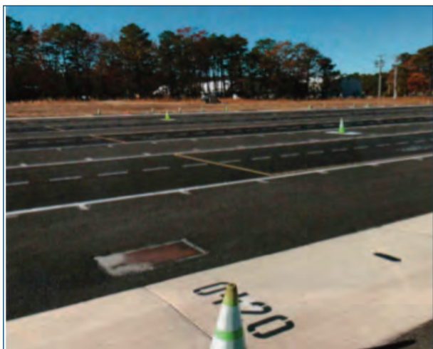
Fig. 3 Le piste di prova esterne per le prove accelerate full-scale del Centro NAPMRC
