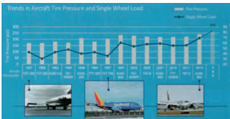
Fig. 1 Andamento negli anni della pressione degli pneumatici degli aerei (diagramma a barre e ordinata di sinistra) e del carico su una singola ruota (linea continua e ordinata destra)
