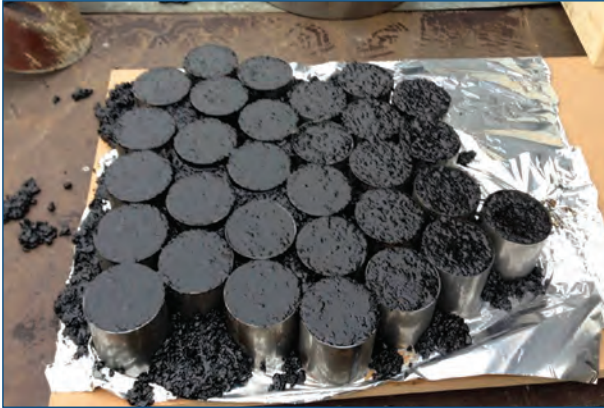
Fig. 8 I provini usati per il nuovo test sull'asfalto colato. Per la prova, si deve asportare lo strato superficiale, onde rendere liscia la superficie
