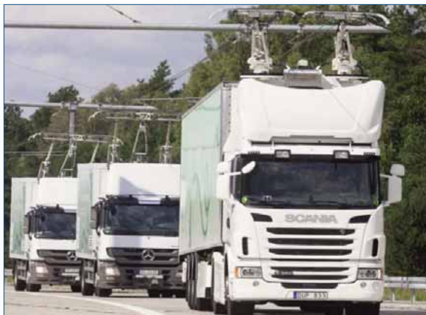
Fig. 7 Trasporto merci su camion elettrici collegati a catenarie
