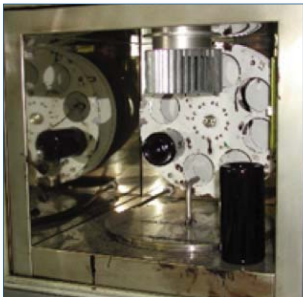
Fig. 2 Apparecchiatura per il test Rolling Thin Film Oven, indurimento su strato sottile
