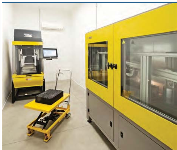
Attrezzatura per prove di ormaiamento su conglomerati bituminosi
