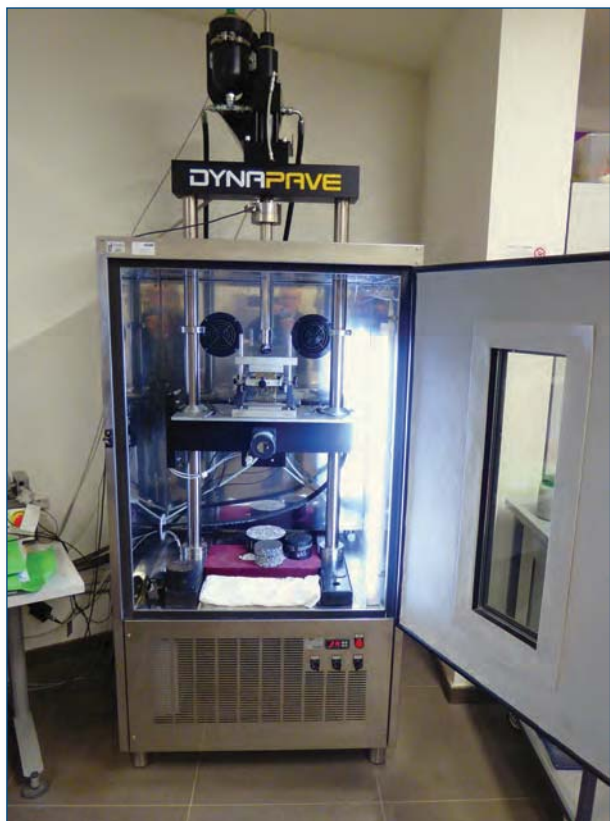
Pressa dinamica per prove prestazionali sui conglomerati bituminosi
