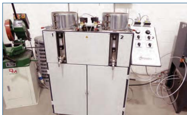
Attrezzatura per la determinazione dell'espansione volumetrica delle loppe di acciaieria
