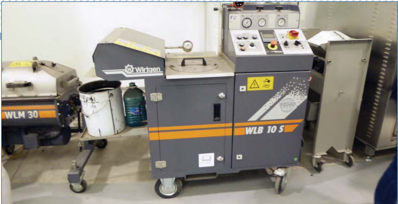
Attrezzatura per controllare le caratteristiche di schiumatura del bitume per riciclaggio a freddo
