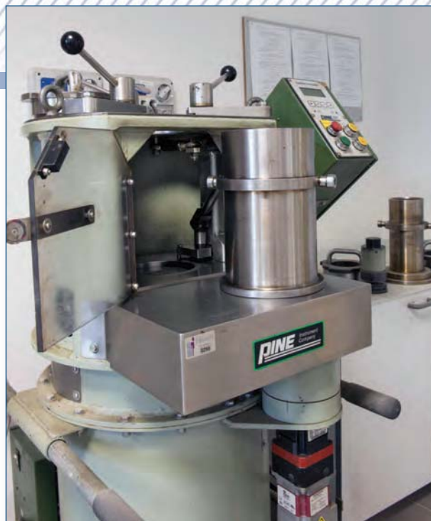
Pressa giratoria per compattazione provini di conglomerato bituminoso e di materiali legati con leganti idraulici
