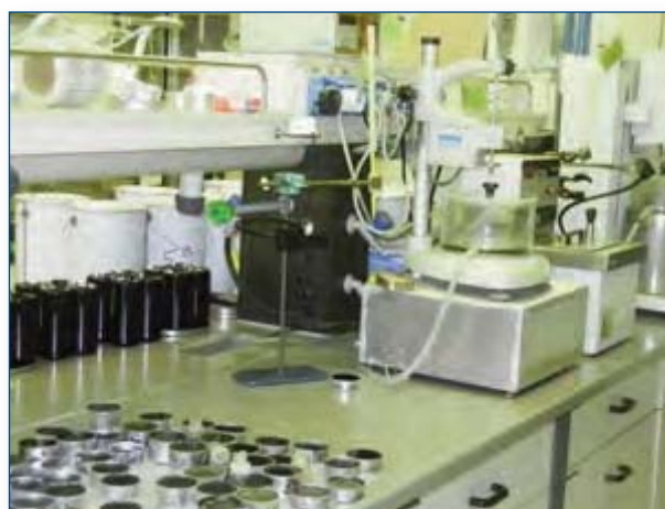
Il laboratorio con le apparecchiature SHRP Superpave
