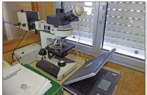
FIG. 4 Verifica della dispersione del polimero nei PMB tramite microscopia ottica
