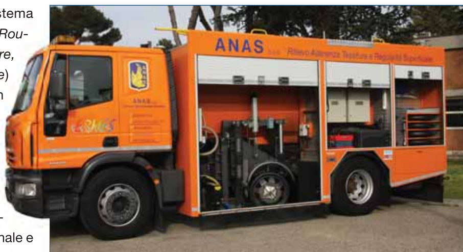
Il mezzo ERMES per le misure delle caratteristiche superficiali delle pavimentazioni
