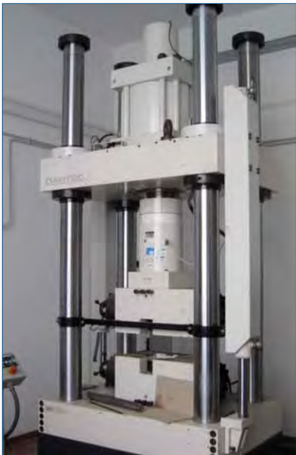
Macchina per la misura della resistenza degli acciai
