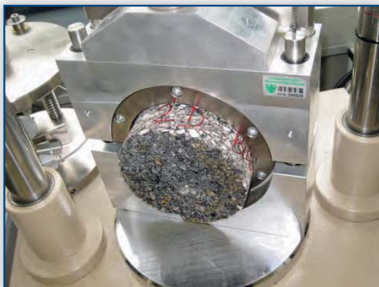
Fig. 6 Prova di taglio secondo Leutner
