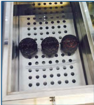
Fig. 5 Determinazione della sensibilità all'acqua secondo UNI EN 12697-23
