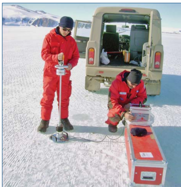
Prove sulla pista in ghiaccio mediante Piastra Dinamica LWD
