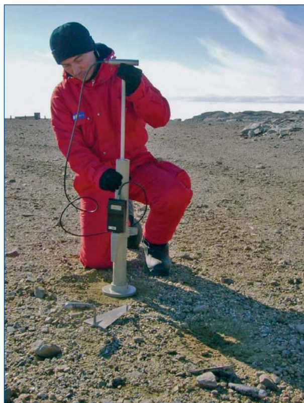
Il Col. Germinario durante la verifica della strumentazione Hammer Test
