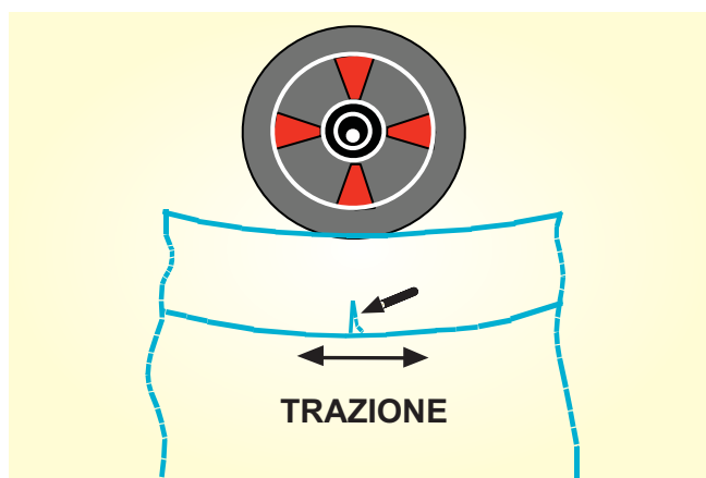
Fig. 1 Comportamento a fatica di una pavimentazione
