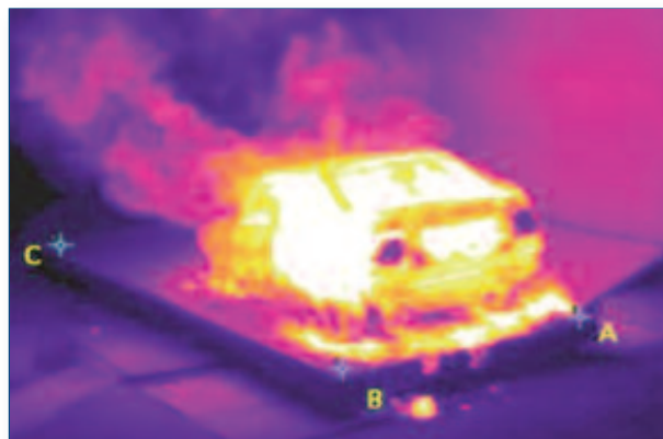
Fig. 6 Evoluzione della temperatura di superficie del conglomerato bituminoso durante le prove con l'auto bruciata
