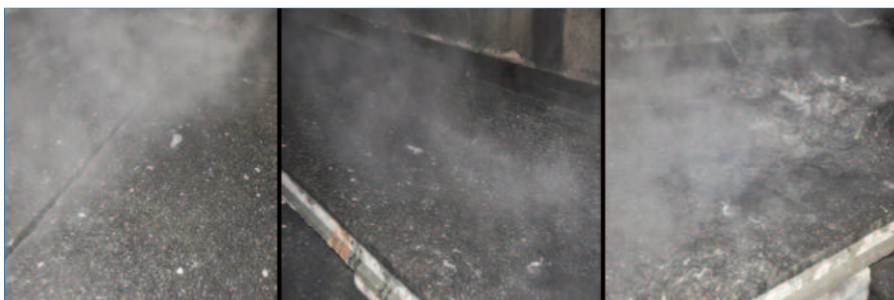
Fig. 7 Aspetto della superficie dell'asfalto dopo la prova di combustione con l'auto
