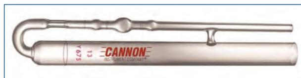
**Fig. 7** Il viscosimetro capillare per i bitumi
