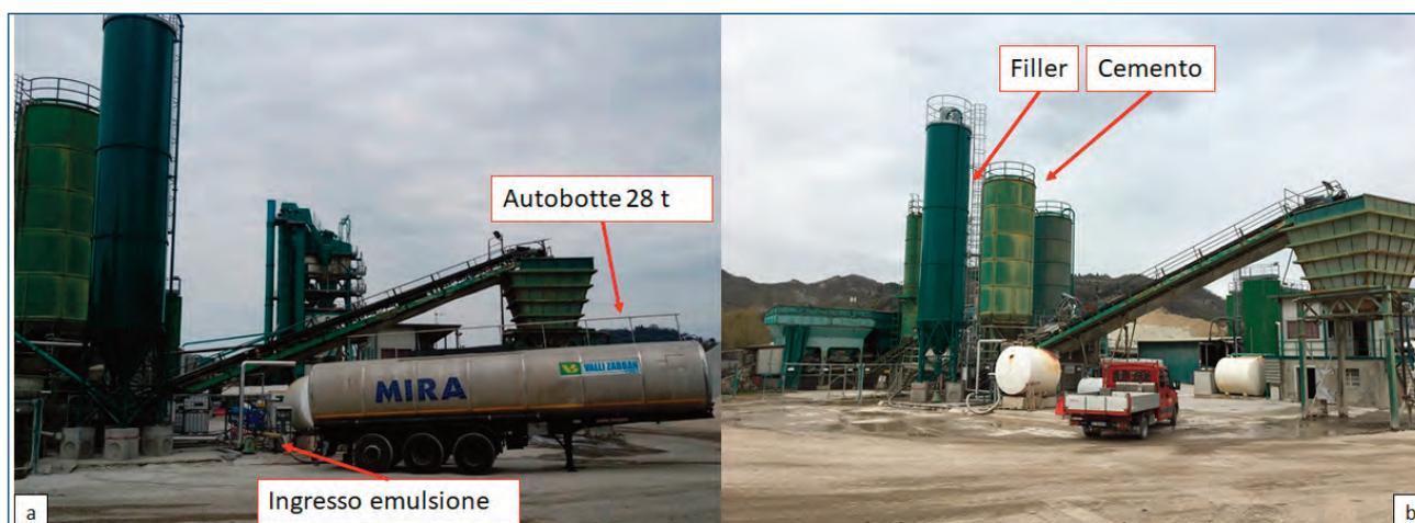
Fig. 3 Impianto adattato per la produzione di miscele riciclate a freddo con emulsione, cemento e integrazione di filler
