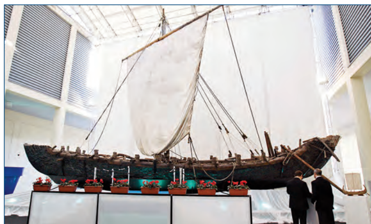
Fig. 13 La copia dell'antica nave di Magan (Oman), fatta di giunchi, con lo scafo ricoperto di asfalto naturale
