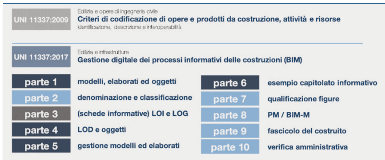
Fig. 5 Struttura della norma UNI 11337-17: in blu scuro le parti pubblicate nel 2017, in grigio la parte ancora in vigore del vecchio assetto del 2009, in celeste le parti pubblicate e/o di prossima uscita (tratto da ingenio-web.it)
