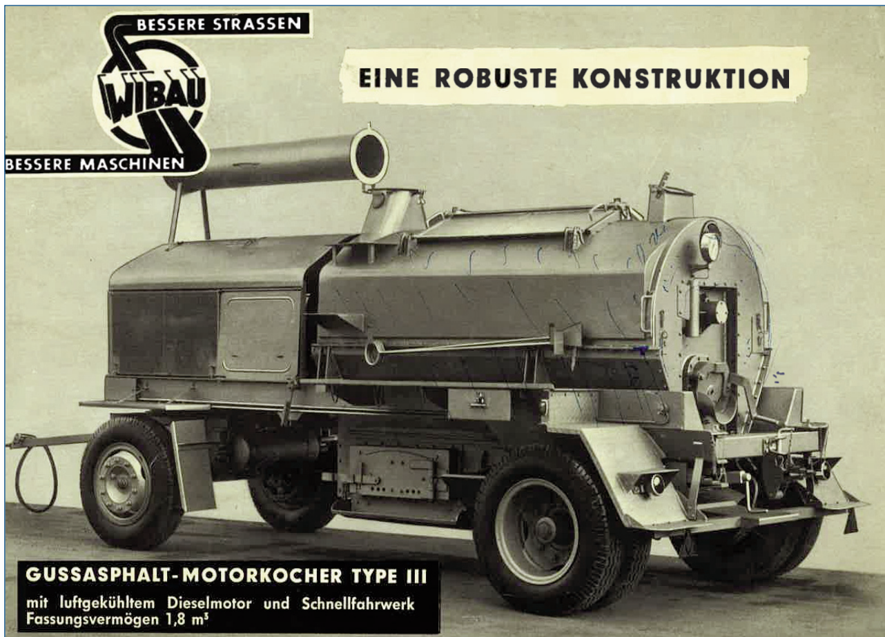
Fig. 2 Storica caldaia mobile per il gussasphalt
