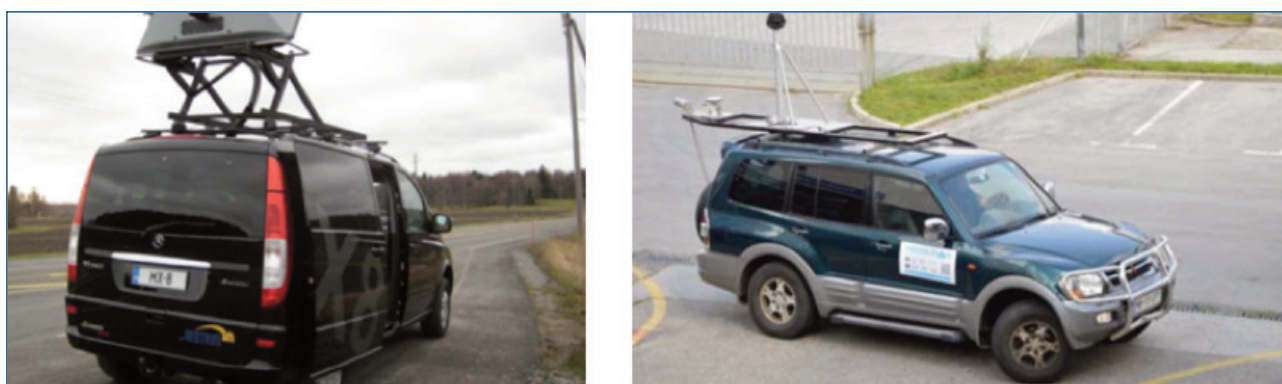
Fig. 7 Sistemi di rilevamento laser-scanner e LIDAR
